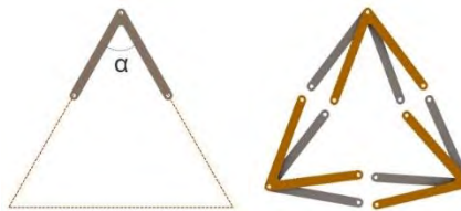
Figura 7. Definición de la tijera angulada según la geometría de un triángulo (Torres y De Matos [6])
