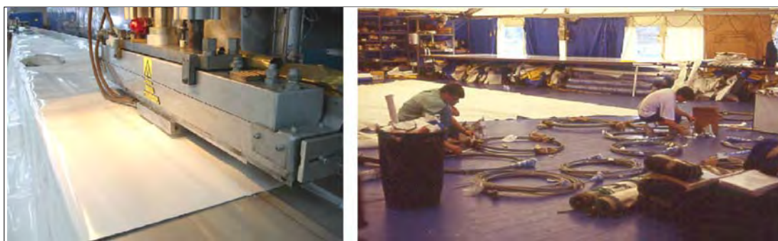
Figuras 20 y 21: Soldadura (izquierda) y etiquetado de cables y accesorios (derecha) en taller.
