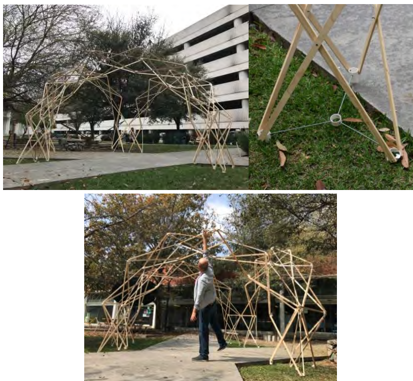
Figura 10: Ensayo de montaje para el núcleo del prototipo y Anclajes para bloqueo de movimiento.
