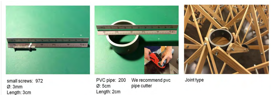
Figura 7: Materiales usados para la estructura del prototipo.
