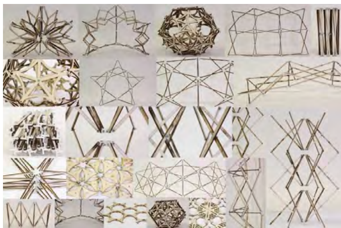
Figura 1: Maquetas a pequeña escala de sistemas desplegados
