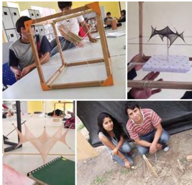
Figura 15: Se muestran algunos ejercicios realizados en los cursos de Estructuras en diferentes escuelas de arquitectura, la búsqueda de equilibrio tridimensional con cuerdas y lonas, o como estabilizar un poste con cables en diferentes direcciones previo análisis gráfico (vectores). Aquí se tiene a la tensión como esfuerzo predominante.
