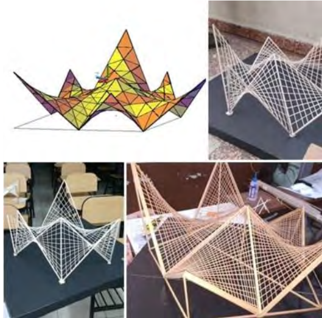
Figura 7: Composición gráfica con paraboloides hiperbólicos realizado en programas CAD en tres dimensiones, además fotografías de modelos de paraboloides hiperbólicos realizados por estudiantes del Curso.
