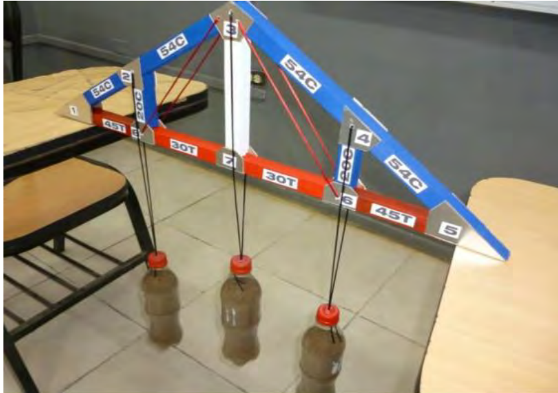
Figura 20: El diseño y construcción de armaduras planas, empieza con el trazado de su geometría, luego la resolución de esfuerzos en cada barra, utilizando el método gráfico por nudos, el cual permite conocer la magnitud y tipo de esfuerzo con un dibujo del equilibrio de esfuerzos en el nudo.
