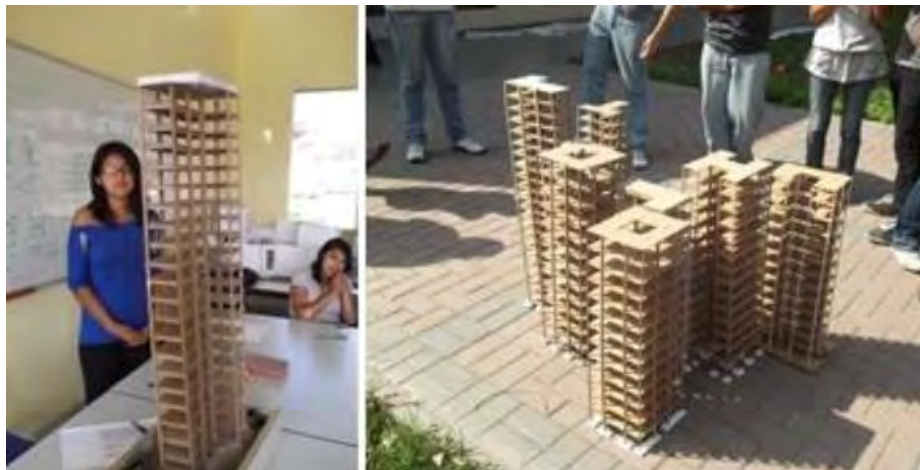
Figura 17: Torres de cartón y madera que simulan edificios de pórticos de 15 a 20 pisos, previamente se han dibujado los planos y hecho el pre dimensionamiento de columnas, vigas y zapatas. Para aprender que forma es mejor para soportar las ondas sísmicas, simulación con diferentes alternativas y configuración en planta (edificios en forma de C, D E, H, T, X, O etc).
